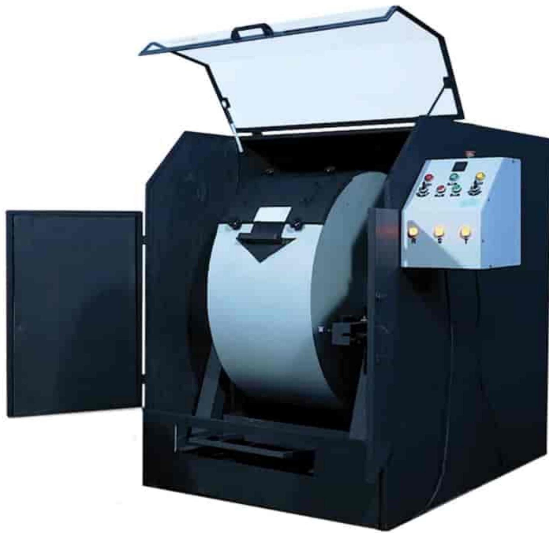
یکی از خواص مکانیکی گندله‌ها، مقاومت آن‌ها در برابر ضربه و سایش است. دستگاه تست مقاومت سایشی (تست تامبلر) به منظور پیش‌بینی رفتار گندله‌ها در شرایط عملیاتی تحت ضربه، برخورد و سایش به کار می‌رود.
