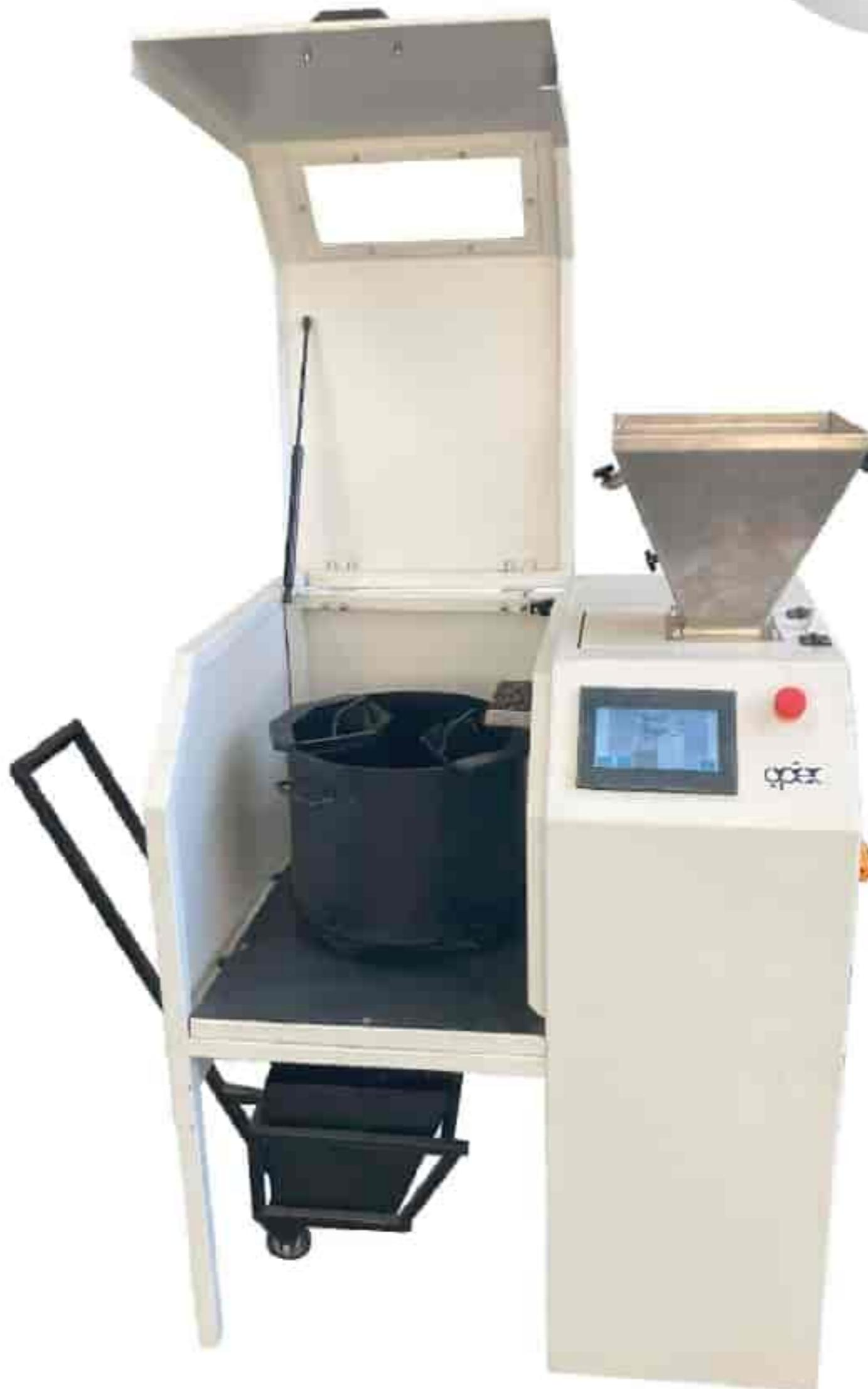
مقسم اتوماتیک به منظور تقسیم یکنواخت نمونه‌های معدنی و با هدف کاهش حجم زیاد نمونه استفاده می‌شود.
