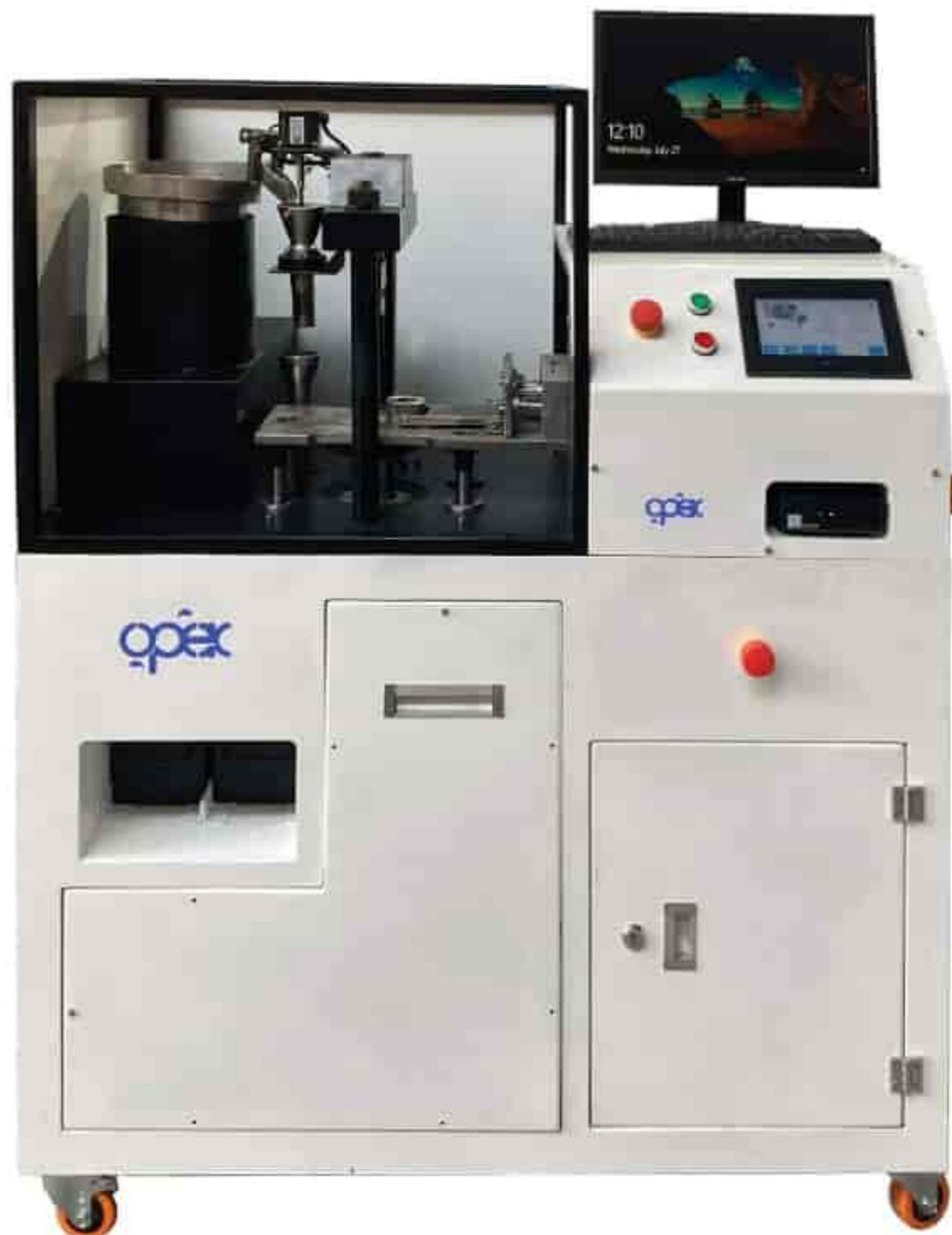
استحکام فشاری گندله پخته به عنوان یک پارامتر مهم در آزمایشگاه‌های کنترل کیفی واحدهای گندله سازی مطرح می‌باشد. جهت اندازه گیری این پارامتر مهم از دستگاه CCS استفاده می‌شود.
