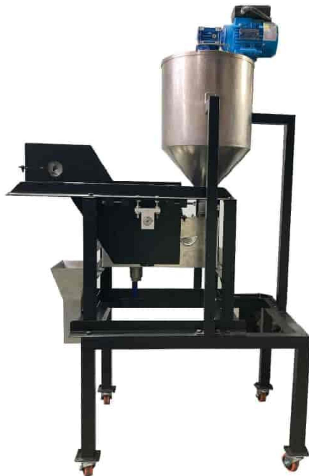
دستگاه درام مگنت تر برای جداسازی و متصرکز کردن مواد مغناطیسی با استفاده از یک آهنربای ثابت که توسط یک پوسته چرخان احاطه شده است، استفاده می شود که حرکت پوسته چرخان، به مواد در تماس با آن منتقل می شود.
