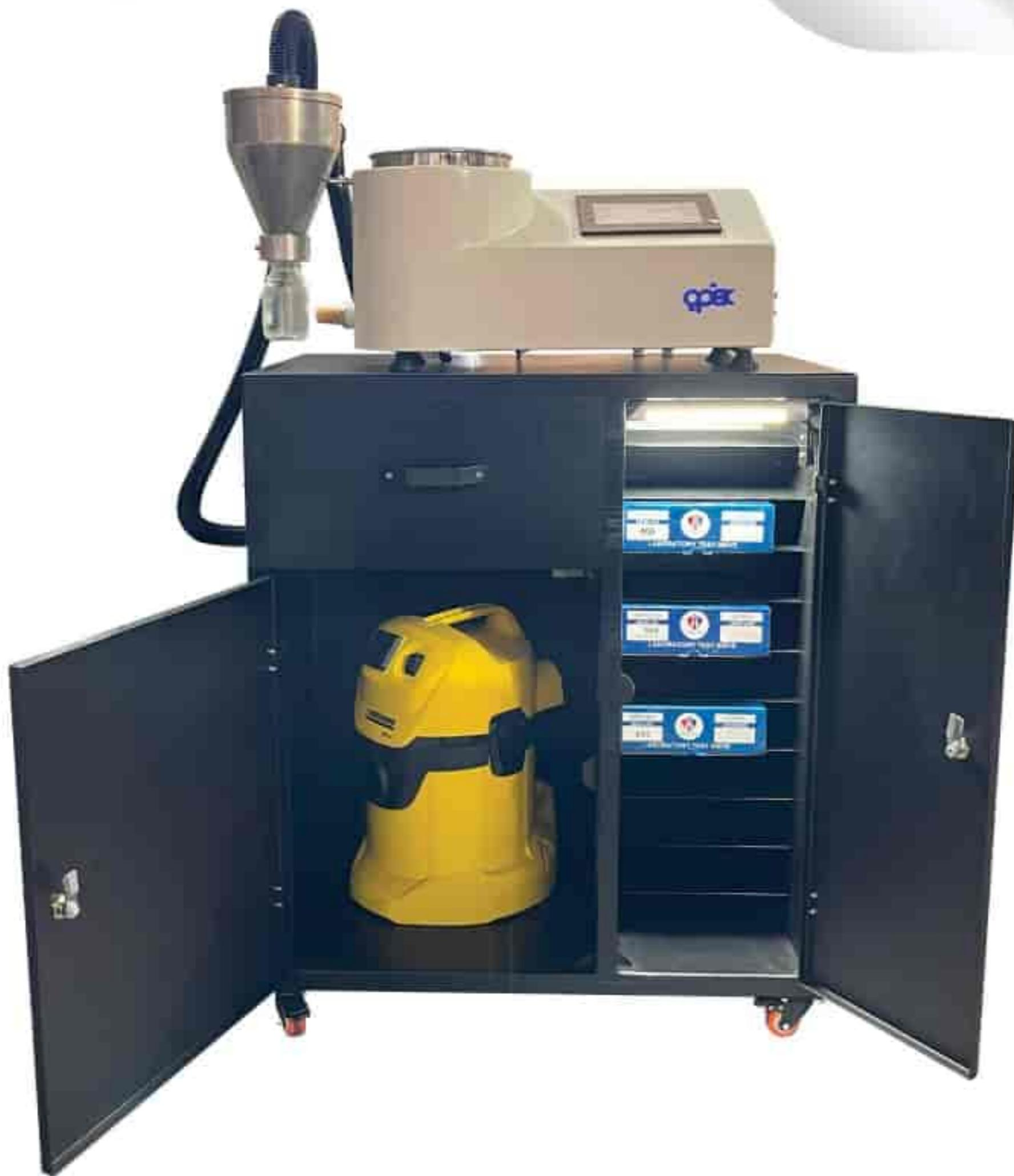
تست ایرجت یکی از دقیق‌ترین روش‌های موجود در آنالیز دانه‌بندی پودرهای صنعتی به صورت خشک می‌باشد. افزایش محسوس دقت و سرعت انجام تست به ویژه در نمونه‌های ریزدانه در مقایسه با سایر روش‌های معمول از ویژگی‌های این دستگاه می‌باشد.
