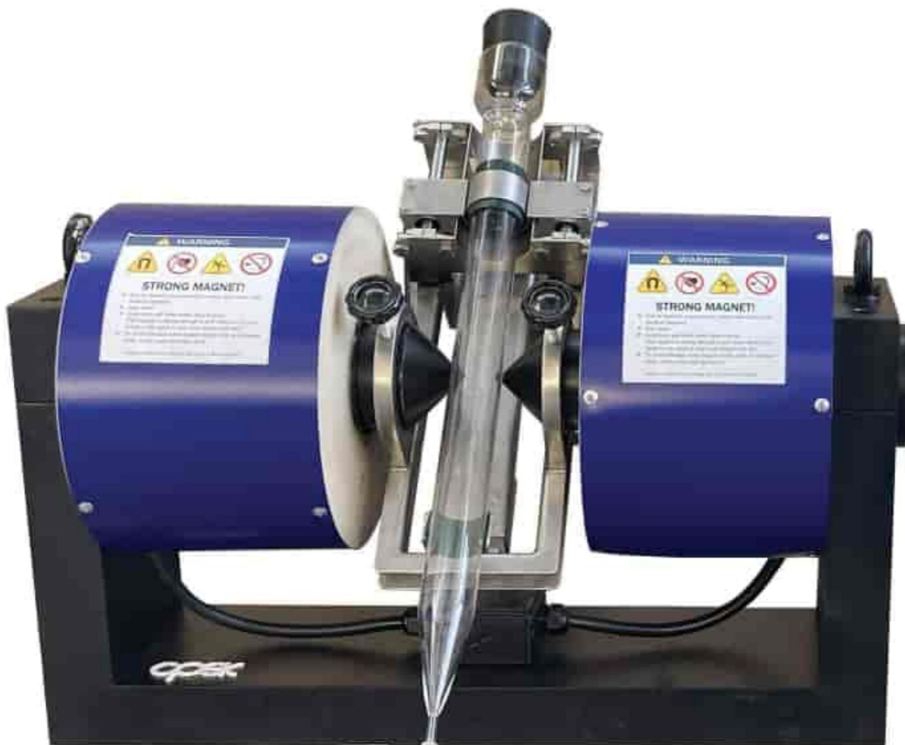
لوله دیویس ابزاری آزمایشگاهی به منظور تفکیک نمونه‌های معدنی به ذراتی با قدرت مغناطیسی مختلف می‌باشد. این تجهیز برای جداسازی سنگ‌های معدنی با شدت مغناطیسی کم نیز قابل استفاده می‌باشد. یکی از مهمترین کاربردهای این دستگاه بررسی میزان درصد آهن و اکسید آهن در سنگ‌های معدنی می‌باشد.
