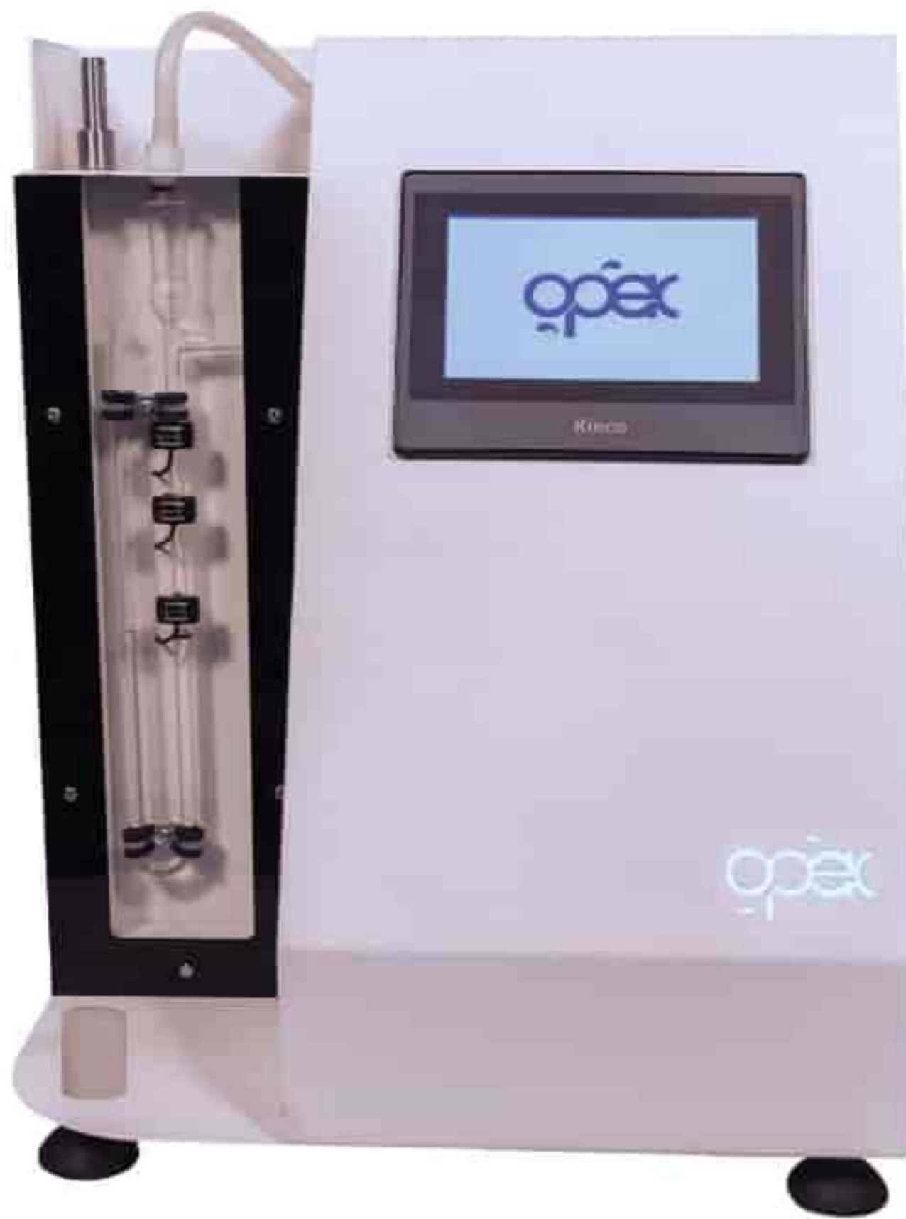
دستگاه تست بلین، سطح مخصوص (سانتی‌متر مربع بر گرم) را با اندازه گیری نفوذ پذیری هوا در نمونه پودر محاسبه می‌نماید. سطح مخصوص پودر معیاری برای سنجش میزان نرمی نمونه می‌باشد.
