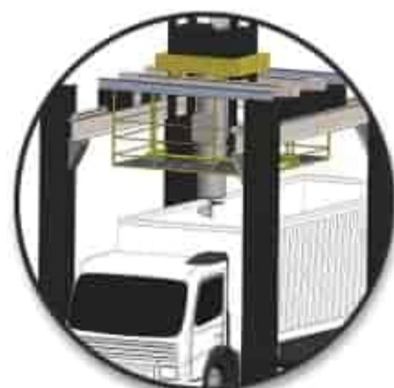
نمونه‌گیری از کامیون و واگن به صورت مشابه عمل می‌کند؛ بدین صورت که در جهت طول و عرض بار جایجا شده و در عمق‌های مختلف قابلیت نمونه‌برداری دارد. به منظور نفوذ تیغه به داخل بار، هم‌زمان از سیستم چرخش هیلکس و هیدرولیک استفاده می‌شود. تعداد نقاط و محل نمونه‌گیری و عمق نفوذ تیغه به داخل بار، در دو حالت دستی و اتوماتیک قابل تنظیم می‌باشد.
