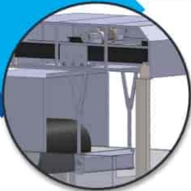
این نوع نمونه‌گیر، مکانیزمی مشابه حالت عرضی ناپیوسته دارد؛ با این تفاوت که حرکت آن طولی است و به سمت نوار نقاله می‌باشد، در نتیجه طول تیغه بیشتر و با عرض نوار نقاله یکسان می‌باشد.
