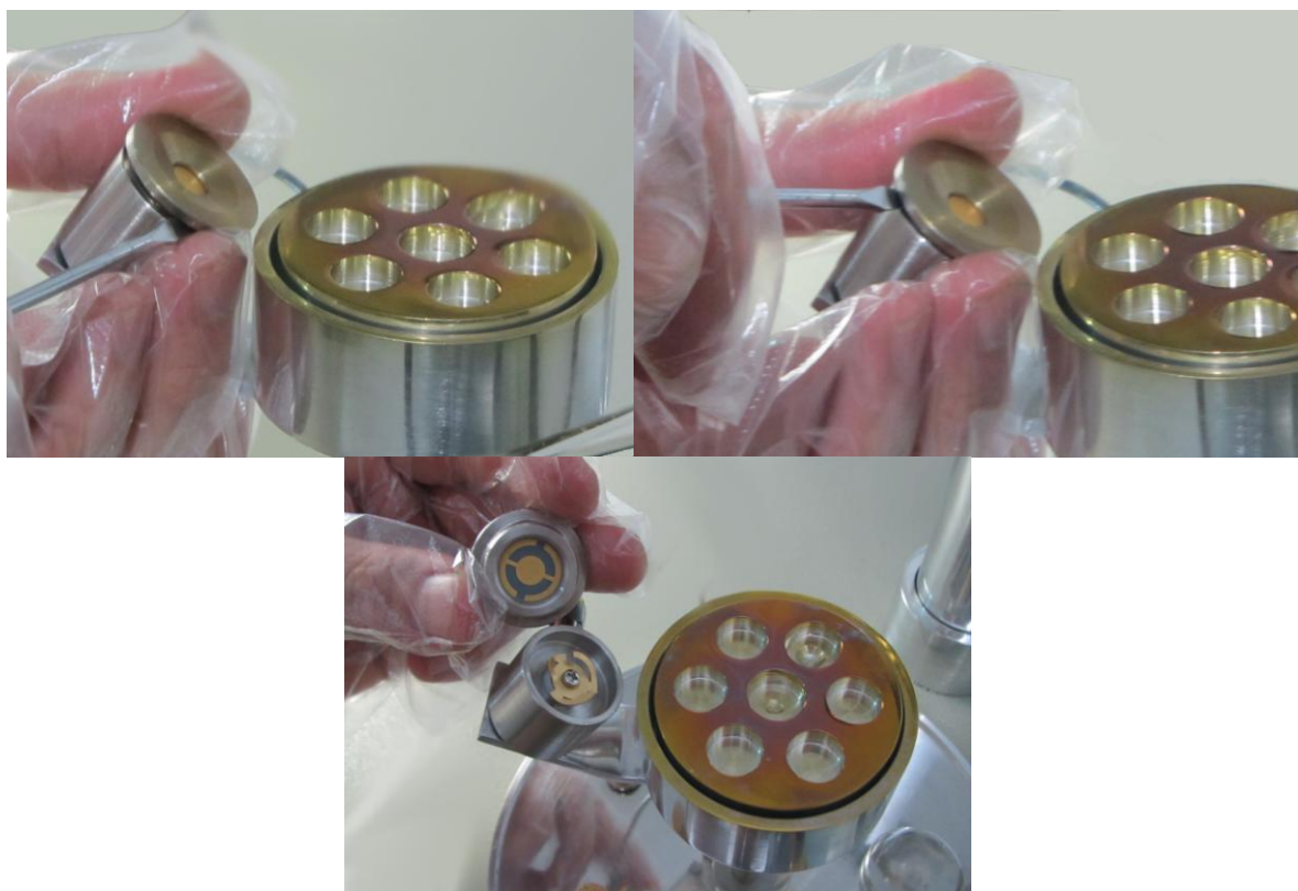
نمای ۱۰ - شیوه باز کردن در ضخامت‌سنج
