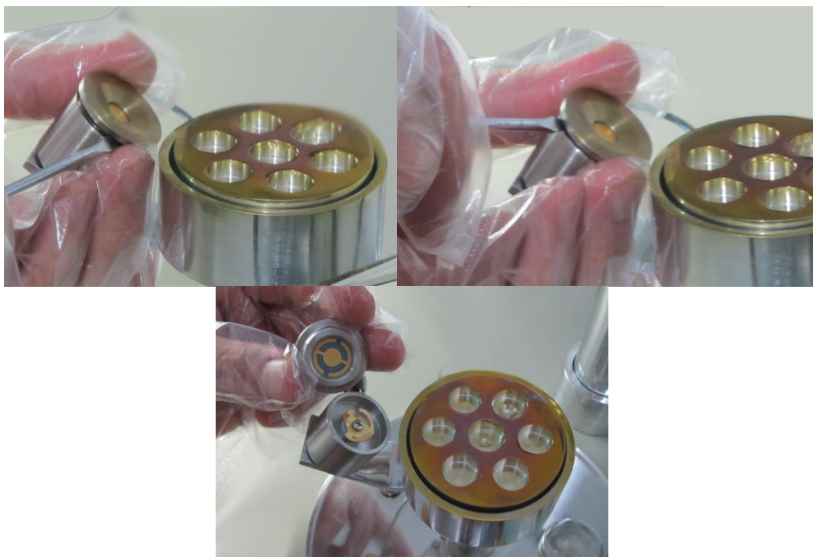
نمای ۱۰ - شیوه باز کردن در ضخامت‌سنج
